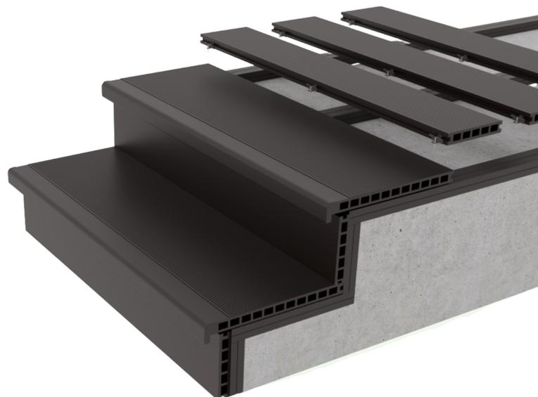
Рис. 8. Пример сборки лестницы.
